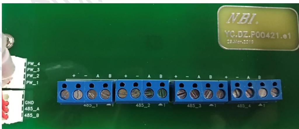
如上图，先把传感器的信号线从灌溉首部控制器外壳上合适的防水接头穿入，再进行接线。接完后拧紧防水接头上的螺母。
